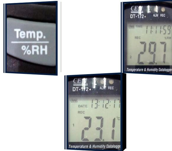
Quando se presiona el botón MAX/MIN, el dispositivo mostrará el valor máximo ó minimo de temperatura ó humedad relativa registrada desde el inicio de la grabación, junto con la fecha y hora de esos registros.
